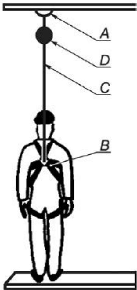
А - анкерная точка; В - страховочная привязь; С - втягивающийся строп (отдельная деталь средства защиты втягивающего типа); D - страховочное устройство (средство защиты втягивающего типа)
