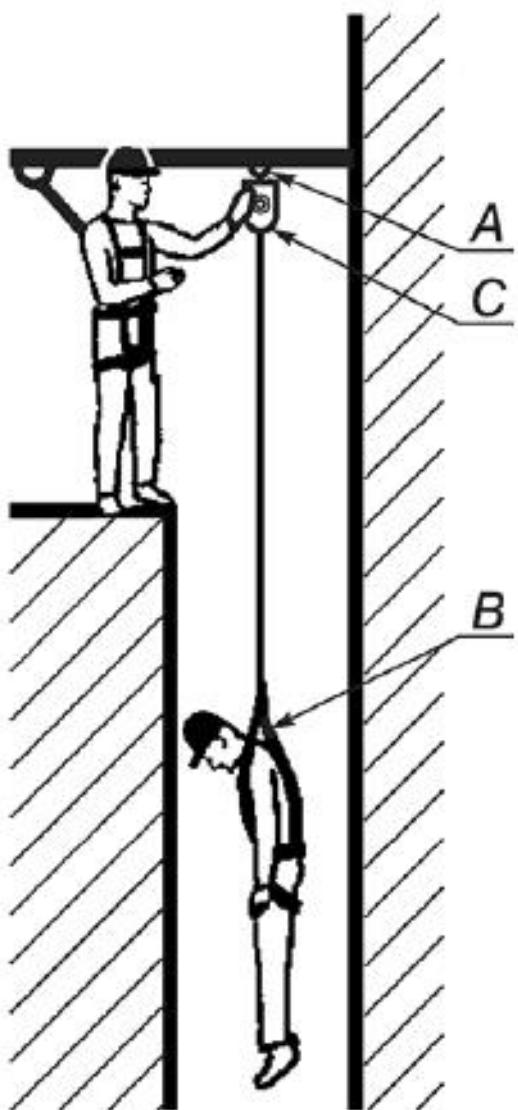
А - анкерная точка; В - устройство для поддержания тела (спасательная привязь); С - подъемное спасательное устройство
