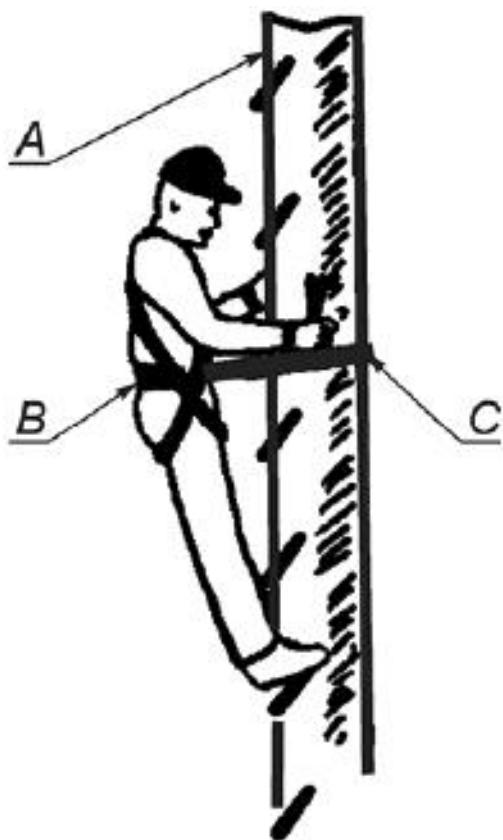
А - крепление; В - привязь; С - строп для системы позиционирования
