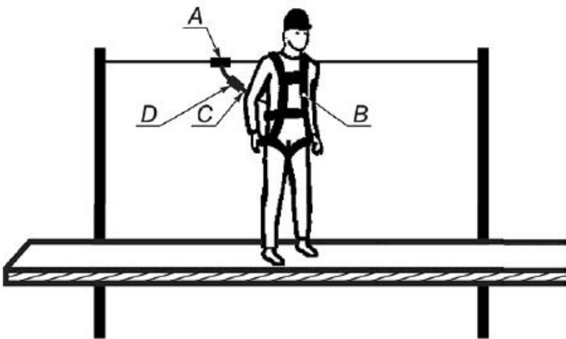
А - подвижная анкерная точка на гибкой горизонтальной анкерной линии; В - страховочная привязь; С - строп; D - амортизатор
